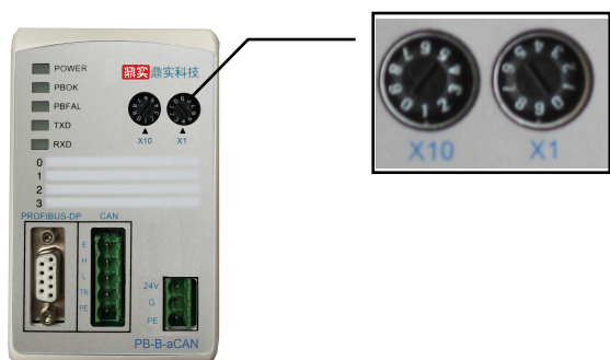
图 2-10 PROFIBUS 从站地址设置开关 SA，地址设为 19
